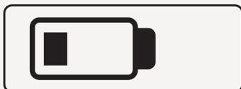
Cuando este símbolo aparezca, indica que hay falla en las baterías del teclado y deben ser cambiadas por unas nuevas. Las baterías se encuentran ubicadas en la parte inferior del teclado, para cambiarlas o instalarlas debes retirar la tapa. Son 2 baterías AA.
