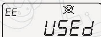
Cuando aparezca en la pantalla del teclado la palabra USED y una carita con una X, indica que el PIN de 20 dígitos ya había sido ingresado y utilizado en el medidor de tu vivienda o negocio anteriormente. Debes acercarte a un punto autorizado y realizar una nueva compra.
