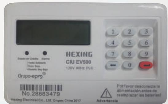
**A. El teclado numérico:** te permite ingresar el código de 20 dígitos o PIN para cargar el medidor de energía.
