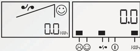
Si se presenta cualquiera de estos dos símbolos, indica que el medidor está sobrecargado por demasiados aparatos conectados. Verifica que los breakers estén encendidos y espera 30 minutos a que el servicio se restablezca solo.
