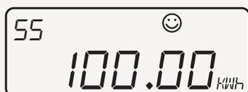
Esta pantalla muestra que se ingresó correctamente el PIN de 20 dígitos porque aparece una cara alegre indicando que la recarga ha sido exitosa. Podrás visualizar la cara en la parte superior y adicional, la cantidad de saldo en energía disponible para utilizar, en este caso, 100 kWh.
