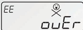
Cuando aparece en la pantalla del teclado la palabra OVER y una carita con una X, esto indica que PIN de 20 dígitos no es aceptado y no podrá ser utilizado debido a que tu medidor sobrepasó la carga máxima permitida. En este caso, deberás esperar a que se consuma parte de la recarga que actualmente tienes y debes volver a ingresar el mismo PIN suministrado en el punto autorizado.
